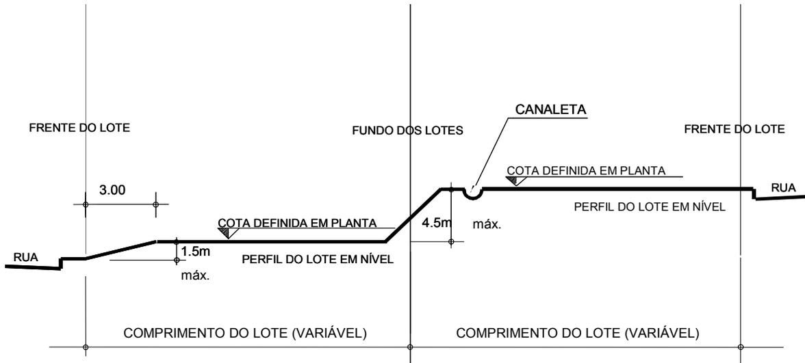
**INCLINAÇÃO DOS TALUDES**
