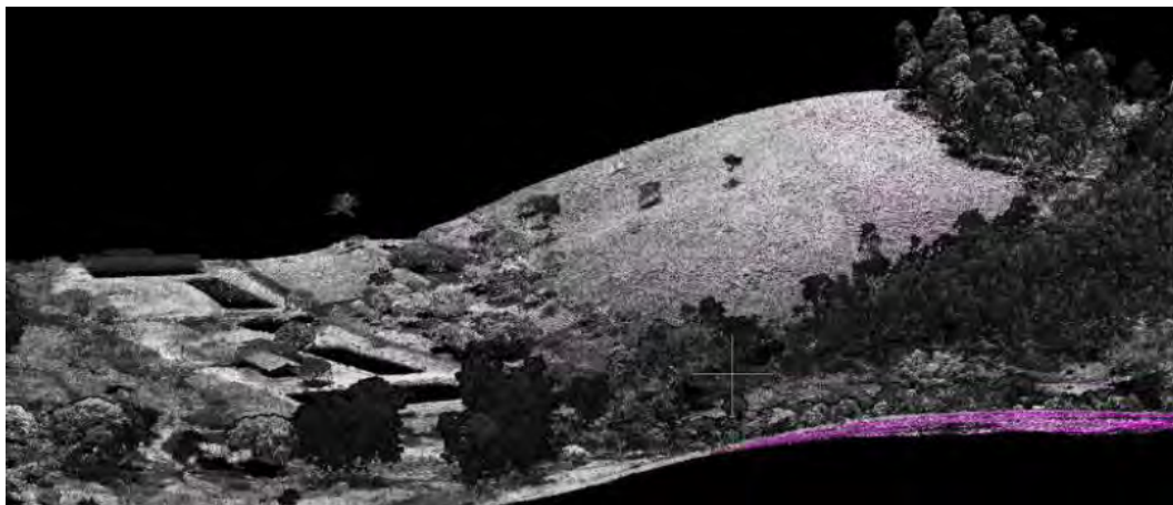
Exemplo de utilização dos dados levantados: nuvem de pontos e modelo digital de superfície
