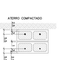
DETALHE 5 ARMADURA LONGITUDINAL ESCALA 1:7,5
